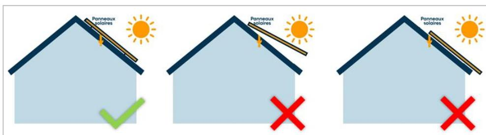
Les panneaux solaires devront, dans la mesure des possibilités techniques, présenter des couleurs harmonieuses avec le reste de la toiture. Sur toitures inclinées, ils devront s'inscrire dans un plan parallèle à celui de la toiture sans débord.
